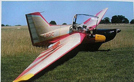
L'aile volante AV 222 construite par Jean Claude Néglaï est caractéristique des productions de Charles Fauvel. On notera l'immense dérive destinée à compenser la faible longueur du fuselage.
