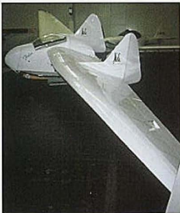
L'AV 36, aile volante bidérive a volé en 1951. Cet appareil est encore utilisé par un club allemand.
